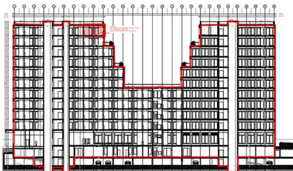
Wärmedämmhülle des Gebäudes
